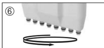
6. Rimontare l'unità di pipettaggio. L'unità di pipettaggio deve essere avvitata all'impugnatura in senso antiorario finché si sente uno scatto. Verificare la tenuta dello strumento (vedere pagina 102 "Manutenzione").
