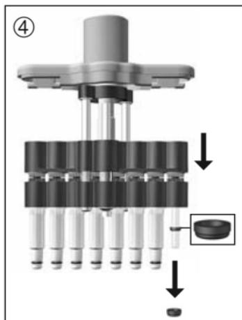
4. Spingere completamente in basso l'assieme del pistone. Dopo lo smontaggio del gambo, la guarnizione può rimanere sul gambo o sul pistone. Rimuovere e verificare la guarnizione. Se necessario pulirla o sostituirla. Se necessario lubrificare leggermente i pistoni con l'olio al silicone fornito con lo strumento.
