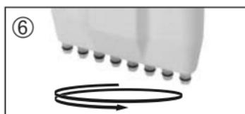
6. Remonter la partie pipetage. La partie pipetage doit être vissée sur la poignée dans le sens inverse des aiguilles d'une montre jusqu'à ce qu'elle s'enclenche avec un déclic. Vérifier l'étanchéité de l'appareil (voir page 58, «Entretien»).
