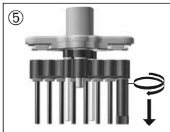
1. Separare l'unità di pipettaggio dall'impugnatura.
