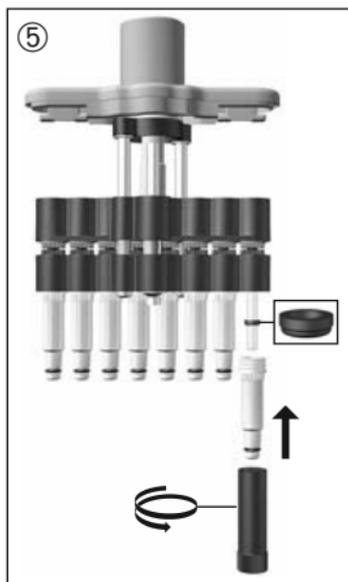
5. Inserire le guarnizioni sui pistoni con la parte piana rivolta verso l'alto. (Per la Transferpette® S -8/-12 30-300 µl, prima reinserire la guarnizione aggiuntiva.) Avvitare i gambi puliti o nuovi con la chiave per il montaggio.
