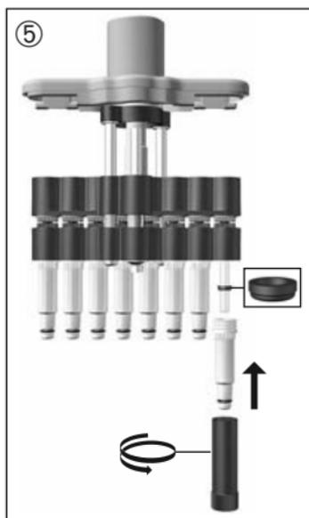
5. Glisser le joint d'étanchéité sur le piston, le côté aplati vers le haut. (Pour la Transferpette® S-8/-12 30-300 µl tout d'abord remettre la bague de pression complémentaire!) Visser la tige nettoyée ou neuve avec la clé de montage.
