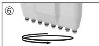
6. Montar otra vez la parte dosificadora. Enroscar la parte dosificadora en sentido inverso a las agujas del reloj sobre la empuñadura, hasta que encaje de forma audible. Comprobar la hermeticidad del aparato (véase pág. 80 „Mantenimiento“).
