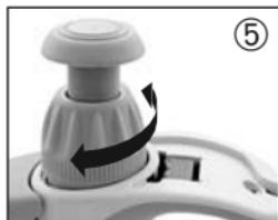
5. Régler la valeur réelle (valeur d'ajustage) déterminée précédemment avec la molette de réglage du volume dans l'état UNLOCK. Un contrôle de volume est conseillé après chaque ajustement.
