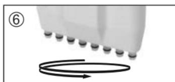
6. Pipettiereinheit wieder zusammenbauen. Die Pipettiereinheit muss gegen den Uhrzeigersinn so auf das Griffteil geschraubt werden, dass sie hörbar einrastet. Gerät auf Dichtheit prüfen (siehe Seite 14 „Wartung“).
