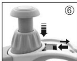
4. Roten Justageschieber vollständig nach hinten schieben, Volumeneinstellknopf hochziehen (Entkopplung) und Justageschieber loslassen.
