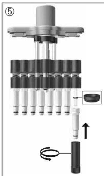
5. Dichtung mit der flachen Seite nach oben auf den Kolben schieben.
