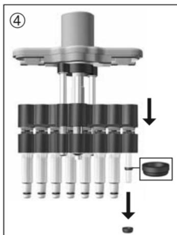
4. Kolbeneinheit ganz nach unten schieben. Die Dichtung befindet sich nach dem Entfernen des Schaftes entweder im Schaft oder auf dem Kolben. Dichtung entfernen, überprüfen und ggf. reinigen oder auswechseln. Bei Bedarf, Kolben mit dem mitgelieferten Silikonöl leicht nachölen.
