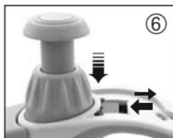
6. Spingere completamente all'indietro la leva di calibrazione, premere il pulsante di regolazione del volume verso il basso e rilasciare la leva di calibrazione. Rimontare l'etichetta e la finestrina.
