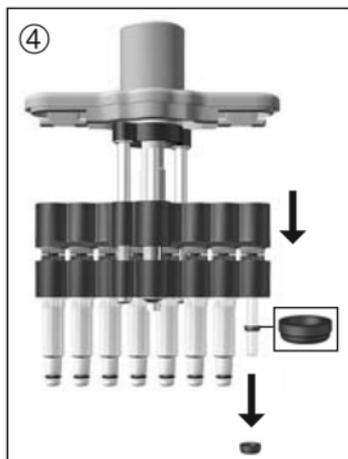
4. Desplazar la unidad de émbolos completamente hacia abajo. Tras retirar el vástago, la junta se encontrará bien en el vástago o sobre el émbolo. Retirar la junta y comprobarla. En caso necesario, limpiarla o sustituirla. En caso necesario, lubricar ligeramente el émbolo con el aceite de silicona suministrado con el aparato.
