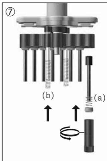
7. Inserire un pistone pulito o nuovo con la molla del pistone (a). Avvitare il dado con la chiave per il montaggio. Inserire le molle della corsa (b).
