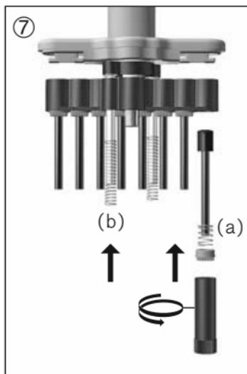
7. Colocar el émbolo limpiado o nuevo y el muelle del émbolo (a) y volver a atornillar fijamente la tuerca del émbolo con la llave de montaje. Colocar los muelles elevadores (b).
