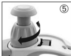
5. Con la manopola di regolazione del volume in posizione UNLOCK, impostare il valore reale (valore di calibrazione) misurato in precedenza.
