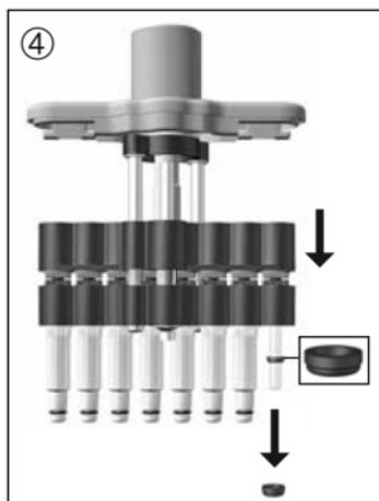
4. Pousser complètement le dispositif de pistons vers le bas. Après avoir enlevé la tige, le joint reste dans la tige ou sur le piston. Retirer et contrôler le joint d'étanchéité, et le cas échéant, le nettoyer ou le remplacer. Si besoin est, lubrifier légèrement le piston en utilisant l'huile de silicone fournie avec l'appareil. (Pour le nettoyage de la Transferpette® S-8/-12 30-300 µl enlever la bague de pression complémentaire du piston.)
