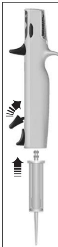
**3.** Emboîter la pointe DD tip droite et verticalement par le bas.
