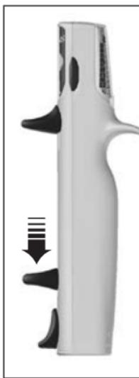
**1.** Pousser le levier de blocage/ remplissage jusqu'à la butée inférieure.
